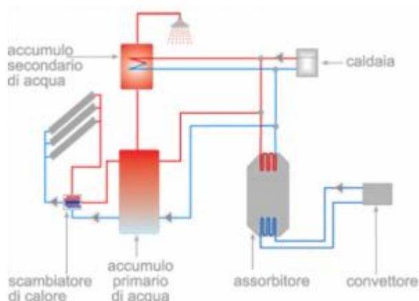
Nella fase di raffrescamento estivo il freddo necessario viene creato dal ciclo frigorifero della macchina ad assorbimento, azionata principalmente dal calore fornito dal campo solare; nella fase di riscaldamento invernale il calore prodotto viene direttamente trasferito nel sistema di distribuzione dell'edificio.
